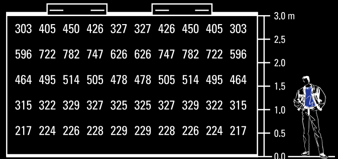
Illumination Distribution for Flare FW255CF (Lux)
